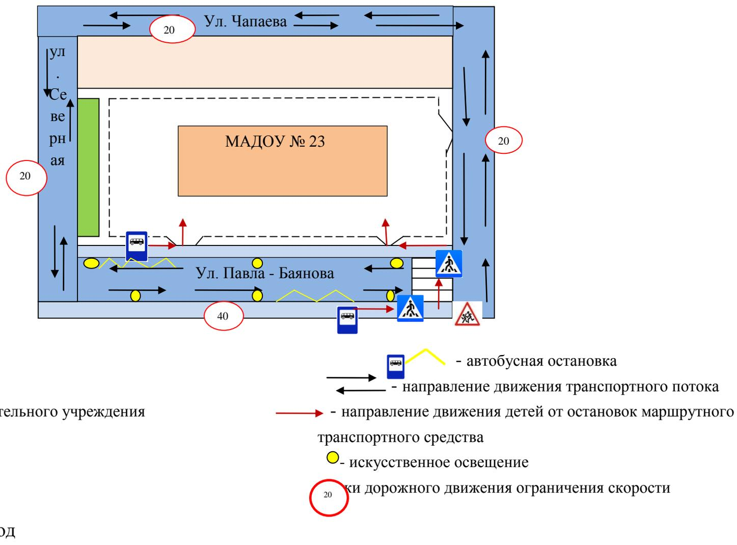
План-схема пути движения транспортных средств и детей при проведении дорожных ремонтно-строительных работ вблизи МАДОУ № 23
